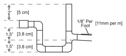
UNIT MUST BE LEVEL OR SLIGHTLY PITCHED TOWARD DRAIN CONNECTION
