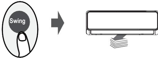
Si continúa presionando el botón SWING (OSCILACIÓN), podrá configurar cinco direcciones de flujo de aire diferentes. Cada vez que presione el botón, la rejilla se moverá en un rango determinado. Presiónelo hasta alcanzar la dirección deseada.
