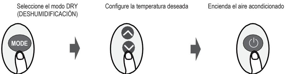
**NOTA:** En el modo DRY (DESHUMIDIFICACIÓN), no se puede configurar la velocidad del ventilador, ya que esta se controla automáticamente.
