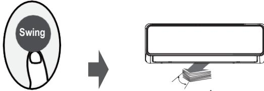
Cuando presiona el botón SWING (OSCILACIÓN), la rejilla horizontal comienza a oscilar hacia arriba y hacia abajo automáticamente. Presiónelo nuevamente para desactivarla.
