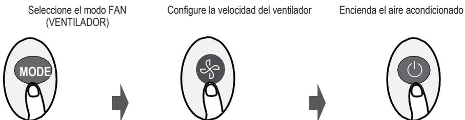
**NOTA:** En el modo FAN, no se puede configurar la temperatura. Por lo tanto, la temperatura no se muestra en la pantalla del control remoto.
