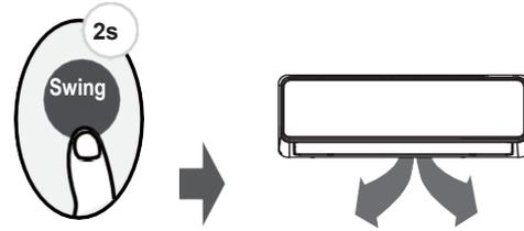
Mantenga este botón presionado durante más de 2 segundos para activar la función de oscilación automática de la rejilla vertical. (Para las unidades con función de oscilación de rejilla vertical)
